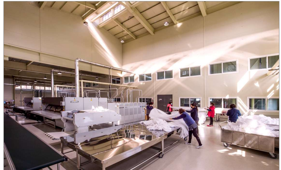
제주런드리 토평세탁공장 B동 전경 [ 검수 → 폴딩 → 포장·패킹 → 출고 공정 ] 3롤 아이로너, 시트폴더 - 스택커 외
