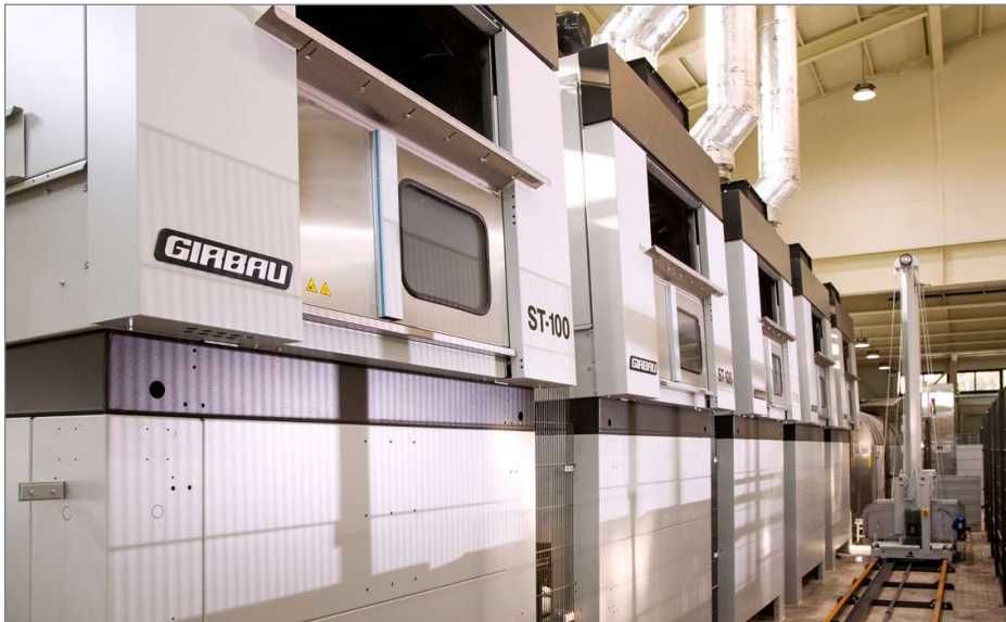
드라이어 [ Steam Heated Dryer 100Kg 스팀 건조기 ]
