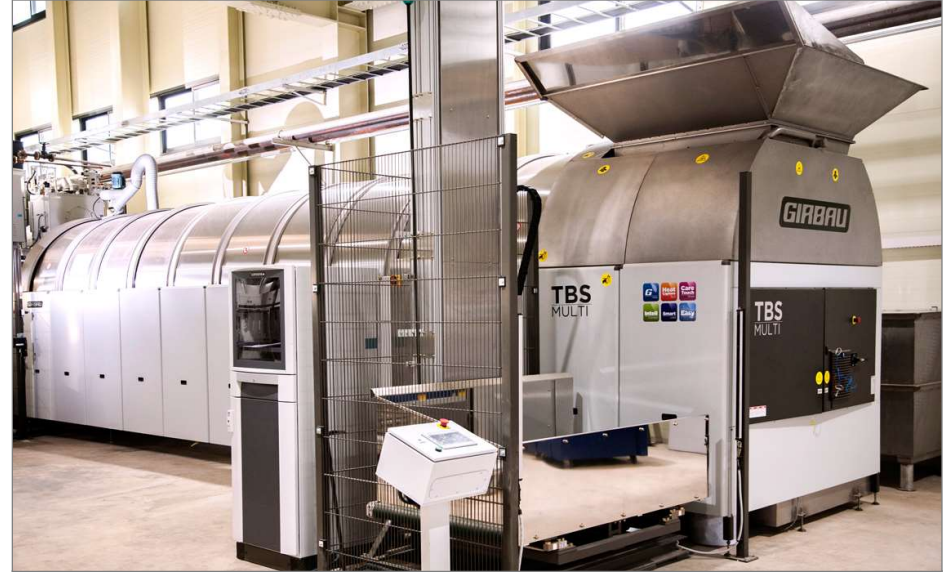
로딩컨베이어 [ ICP-3 50Kg 3칸 자동투입 컨베이어 ] 터널배치 세탁시스템 [ 10칸 배치 연속세탁기; 1일 25 ~ 30톤 세탁처리 가능 ]
